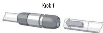
Zatlačte trubku do tvarovky
