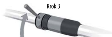
Zajistěte klíčem (nezbytné pouze pro tvarovky o průměru větším než 40 mm (1 1/2"))
